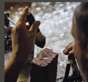
Im richtigen Moment drückt er den Stempel ins heiße Glas.
