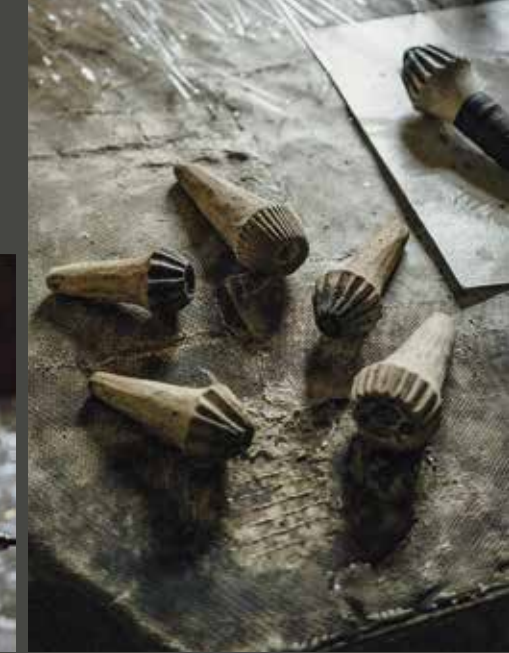
Viele Lauschaer Glasbläser arbeiten noch mit den alten Formen und Werkzeugen. Die Prägestempel von Rolf Köhler haben zahlreiche verschiedene Muster.
