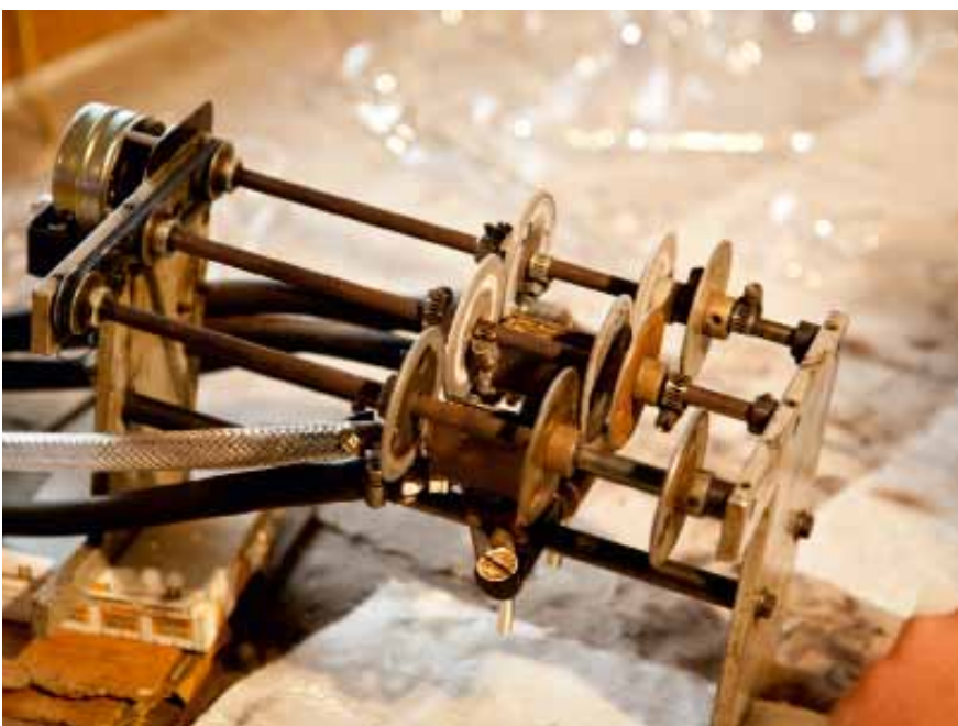
Auf dem Vorwärmer, der sich auf verschiedene Größen einstellen lässt, temperiert der Glasbläser die Rohlinge, bevor er sie in der 1500 Grad heißen Flamme erhitzt
